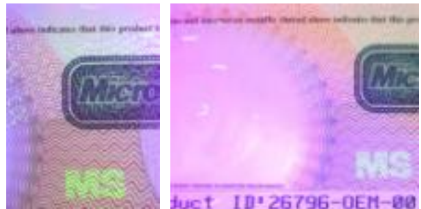
Figure 6 e 7 – Impression et fibres de sécurité UV du certificat d'authenticité Microsoft.
